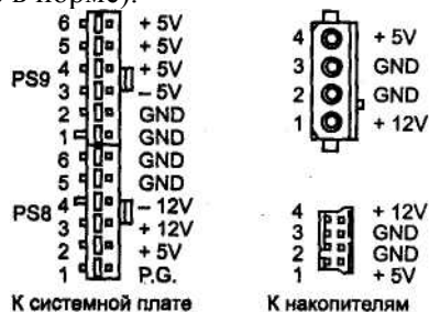
Рис. 13.7. Выходные разъемы традиционного блока питания
