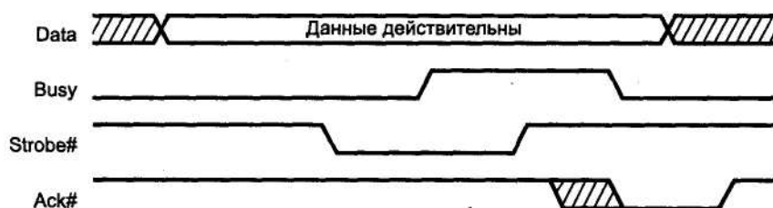
Рис. 8.5. Передача данных по протоколу Centronics
