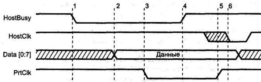
Рис. 1.2. Прием данных в байтном режиме
