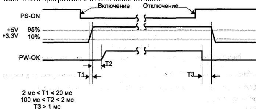
Рис. 13.8. Временная диаграмма интерфейса управления питанием ATX
