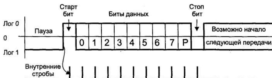
Рис. 2.12. Формат асинхронной передачи RS-232C
