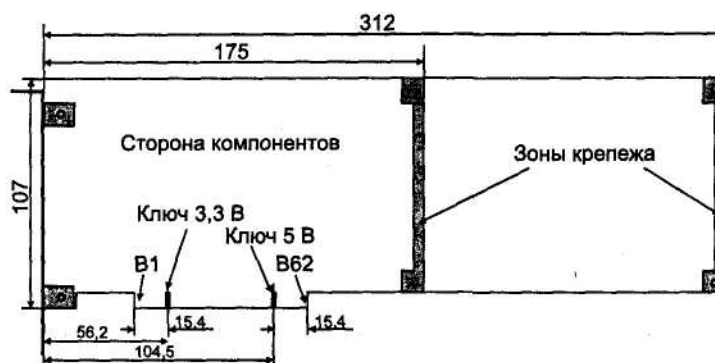
Рис. 6.8. Карта расширения для шины PCI
