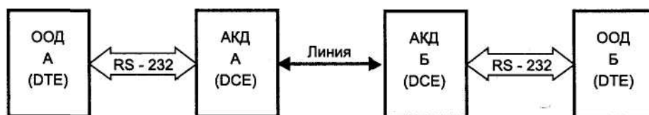
Рис. 2.1. Полная схема соединения по RS-232C
