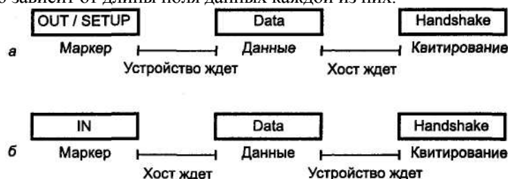
Рис. 4.4. Последовательности пакетов: а — вывод, б — ввод
